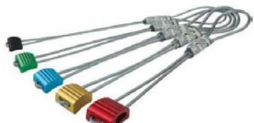
**Frendovi** – su mehaničke naprave koje imaju istu ulogu kao i čokovi, samo se mogu do određenih granica prilagođavati veličini pukotine. Frend se namjesti u pukotinu, a prilikom opterećenja sve jače upire krilcima u zidove pukotine i na taj način sprečava ispadanje. Posebno su pogodni za korišćenje u plafonskim i previsnim pukotinama. Jednostavno se i brzo se postavljaju i sve više koriste u penjanju. Postoje fix i flexi frendovi.
